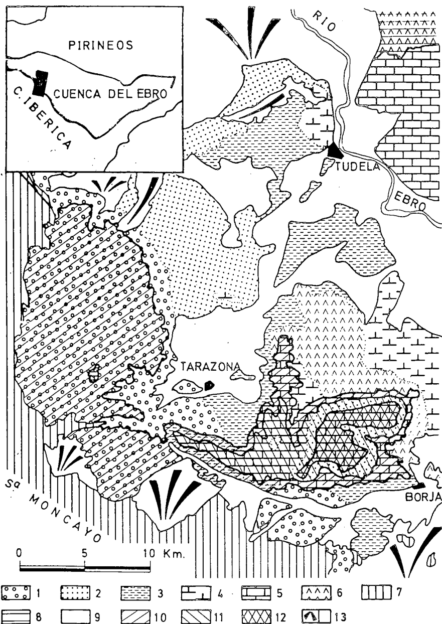
Figura 1. Esquema de situación y cartografía de las unidades. 1. Litofacies conglomeráticas. 2. Arenosas. 3. Lutíticas. 4. Lutítico-carbonatadas. 5. Carbonatadas. 6. Yesíferas. 7. Mesozoico. 8. Yacente terciario. 9. UTS 1. o 10. UTS 2. o 12. UTS 3. o 12. UTS 4. o . 13. Glacis y aluvial cuaternario.
